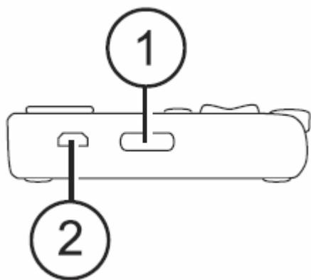
С левой стороны дисплея, следуя от передней панели к задней, вы найдёте кнопку Power (Питание) (1), стандартный микро USB-порт (2). USB-порт позволяет подключать дисплей к компьютеру при помощи поставляемого в комплекте USB-кабеля или к адаптеру питания.
