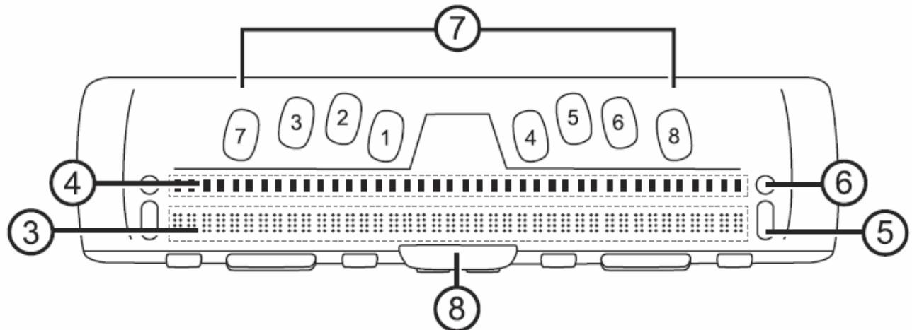
Обновляемые ячейки Брайля (3) расположены на передней панели устройства. Над каждой брайлевской ячейкой находится кнопка перемещения курсора (4), а кнопка навигации расположена непосредственно над каждой кнопкой перемещения курсора. На каждом конце поверхности дисплея расположены NAV Rockers (навигационные клавиши-качельки)(5), используемые для более удобной навигации. Над каждой клавишей NAV Rocker расположены кнопки переключения режимов навигации (6).
