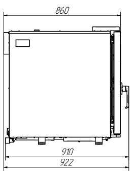
Конвекционная печь электрическая КЭП-6П-01 предназначена для приготовления пищи на предприятиях общественного питания. Управление осуществляется через панель управления, расположенное на двери печи. На панели управления имеются кнопки выбора режима работы и индикаторы, отображающие выбранный режим. В конструкции двери используется ручка с мезанизмом байонет. Дверь имеет возможность фиксации своего положения в открытом состоянии.
