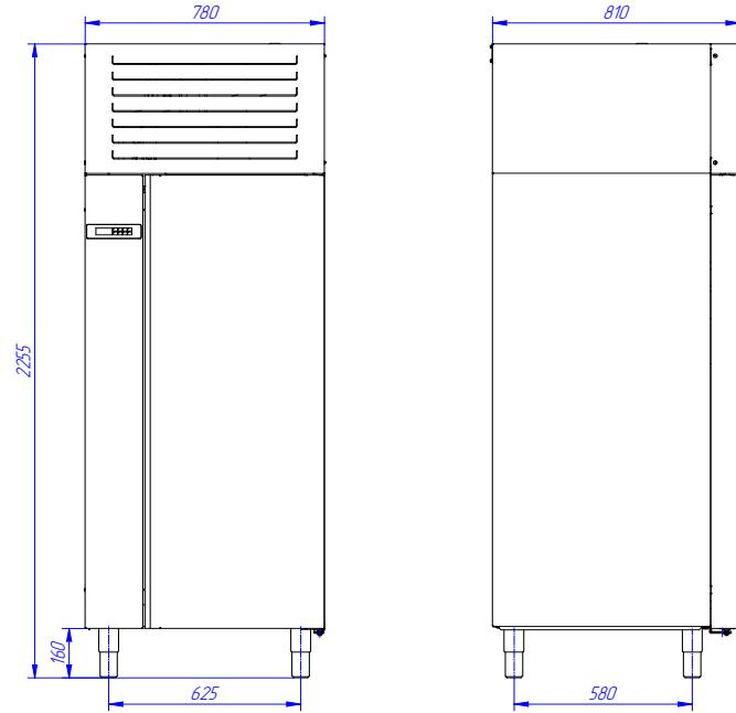
Шкаф шоковой заморозки ШОК-20-1/1Т предназначен для быстрого охлаждения и замораживания различных пищевых продуктов на предприятиях общественного питания и торговли для дальнейшего их хранения.
