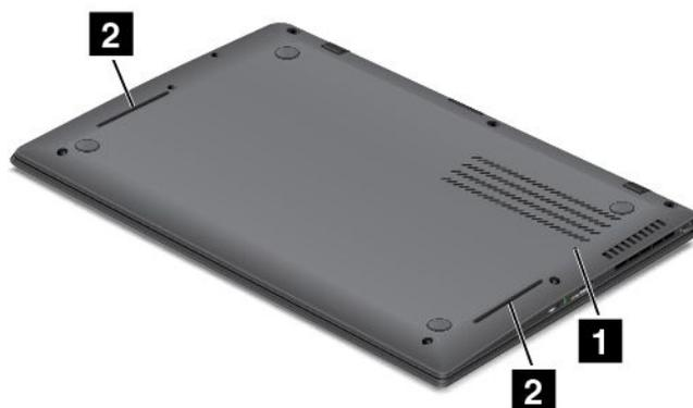
1 Отверстие для аварийной перезагрузки
