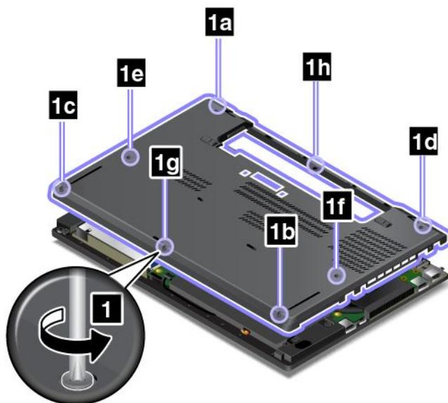
5. Отожмите защелки **1** в восходящем алфавитном порядке (от “a” до “h”), как показано на рисунке, затем снимите узел крышки корпуса **2**.
