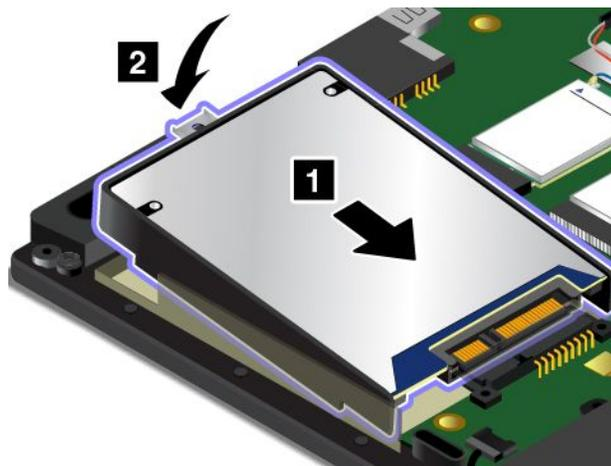
9. Установите винт для фиксации внутреннего устройства хранения.
