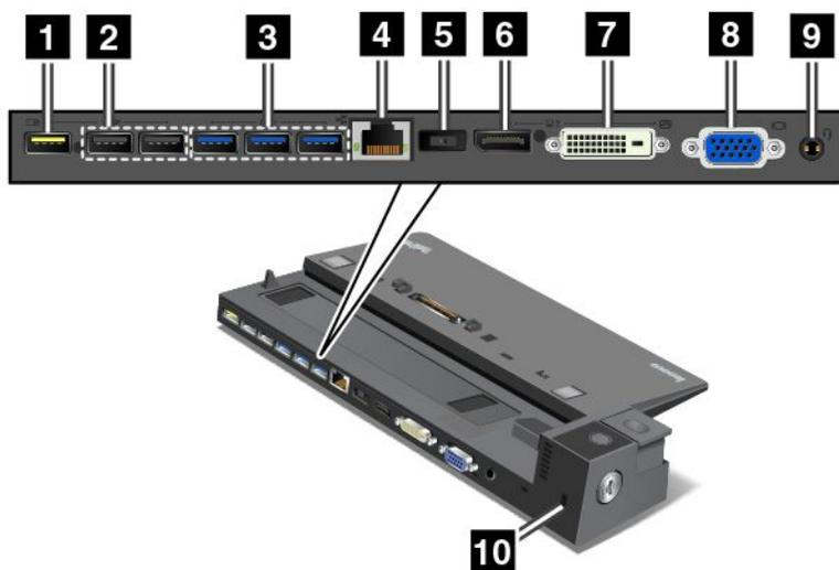
**1 Разъем Always On USB:** используется для подключения устройств, совместимых с USB 2.0, или зарядки мобильных цифровых устройств и смартфонов, когда компьютер находится в режиме сна или гибернации.
