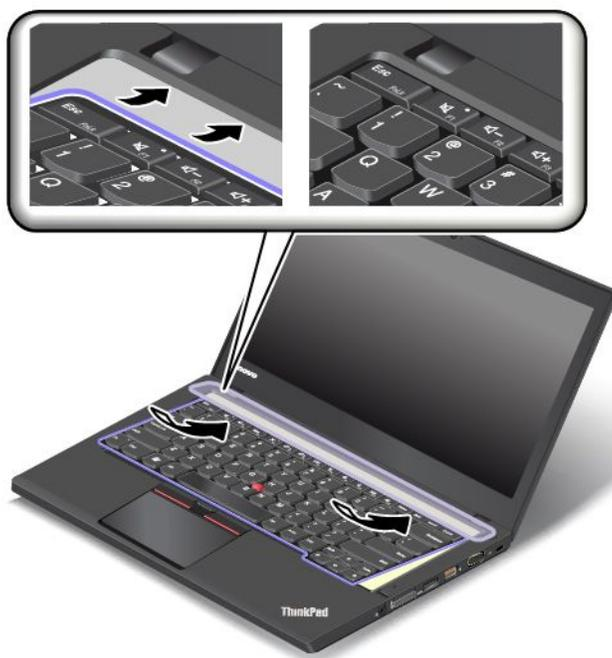
3. Убедитесь, что головки винтов полностью доступны. В противном случае освободите доступ к головкам винтов, сдвинув рамку клавиатуры вперед с помощью плоского торцевого конца многофункционального инструмента для клавиатуры.
