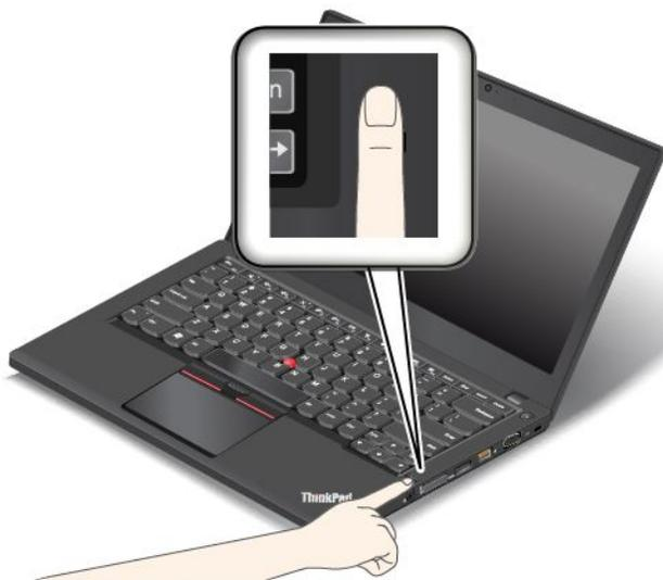
2. Слегка прижмите палец к устройству распознавания и проведите пальцем по устройству к себе одним плавным движением. Не поднимайте палец, когда проводите им по устройству.
