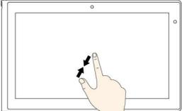
A hand with two fingers touching the screen and moving towards each other, with curved arrows indicating the inward motion.                                                       | <p><b>Касание:</b> сдвиньте два пальца вместе.</p> <p><b>Действие мыши:</b> нажмите клавишу Ctrl при прокрутке колесика мыши назад.</p> <p><b>Функция:</b> уменьшение масштаба.</p>                                                                            |
