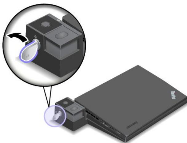
3. Нажимайте кнопку извлечения, пока компьютер не сдвинется вверх. Затем возьмитесь за обе стороны компьютера и отсоедините его.
