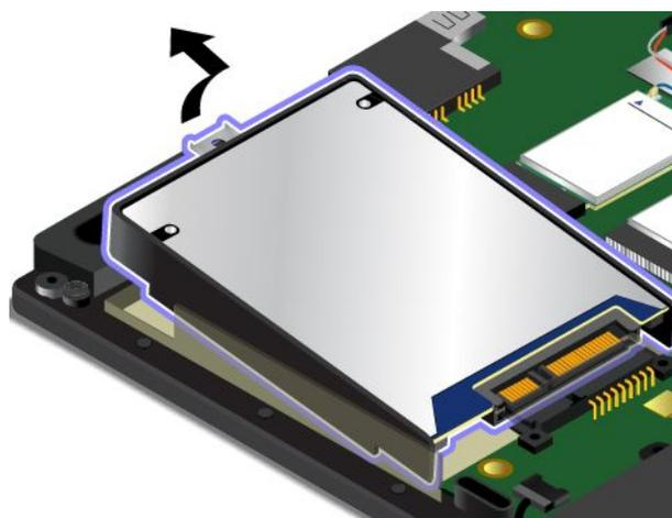
7. Отсоедините крепежную скобу от внутреннего устройства хранения. Затем подсоедините крепежную скобу к новому внутреннему устройству хранения.
