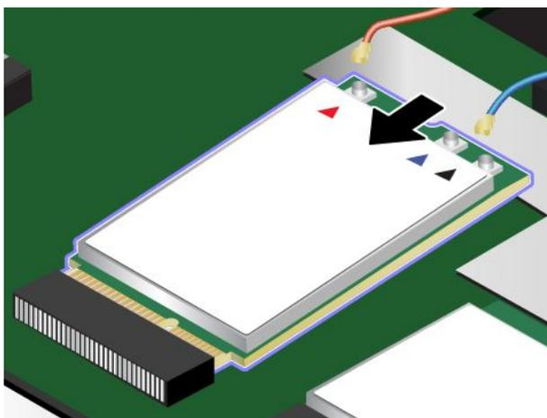
9. Поверните новую карту беспроводной глобальной сети вниз **1**, а затем установите винт для фиксации карты на месте **2**.
