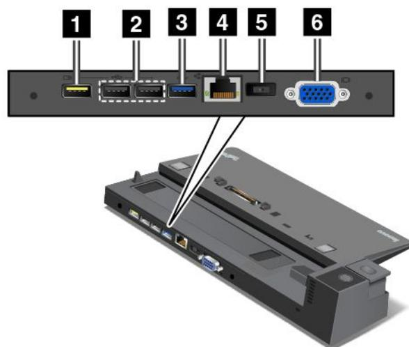
**1 Разъем Always On USB:** используется для подключения устройств, совместимых с USB 2.0, или зарядки мобильных цифровых устройств и смартфонов, когда компьютер находится в режиме сна или гибернации.
