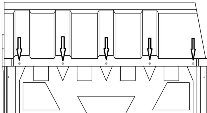
3.21. Прикрепить проушины для замка к двери и арке: просверлить по два отверстия для каждой проушины и закрепить их заклепками:
