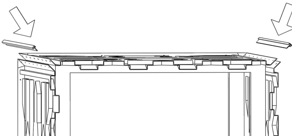
3.3. Выровнять Ш-профиль по нижней части боковой панели согласно эскизу. Ш-профиль не должен иметь изгибов:
