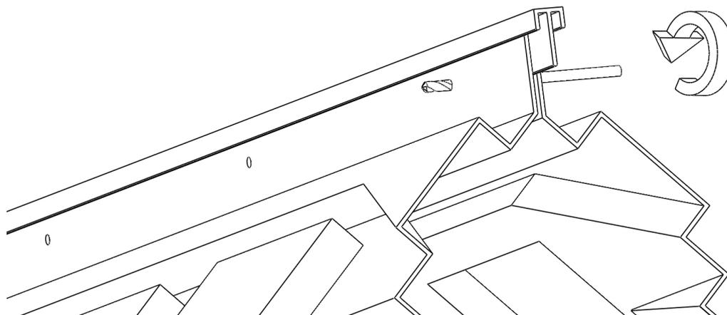
3.5. В просверленное отверстие вставить вытяжную заклепку (4,8x16мм), одеть шайбу и заклепать\*:
