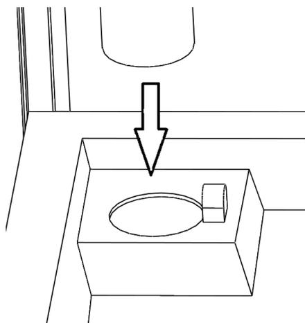
3.12. Просверлить два отверстия диаметром 5 мм в бумагодержателе и боковой панели. Закрепить бумагодержатель на боковой панели с помощью вытяжных заклепок:
