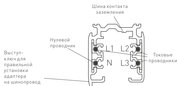
Рисунок 1. Конструкция шинопровода
