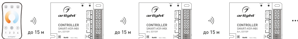
Рисунок 2. Ретрансляция сигнала от пульта ДУ (до 15 м на открытом пространстве)
