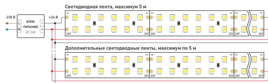
Схема 2. Подключение нескольких светодиодных лент с двух сторон. Рекомендуется использовать для обеспечения равномерного свечения ленты по всей длине.
