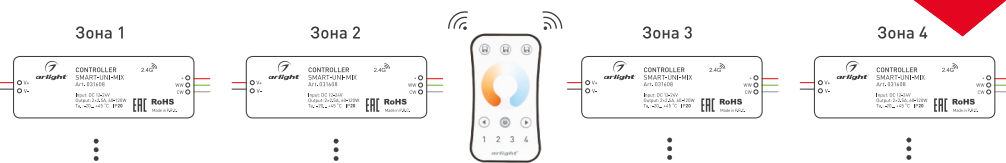
Рисунок 3. Вариант построения системы с 4-зонным пультом дистанционного управления
