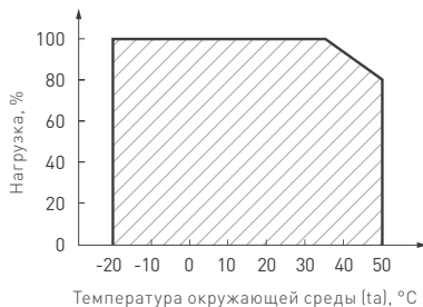
Рис. 2. Максимальная допустимая нагрузка, % от мощности источника.
