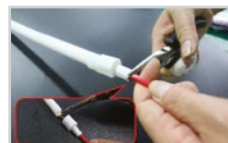
Для герметизации места подключения используйте заглушку под кабель из комплекта поставки. Обязательно герметизируйте место стыка герметиком
