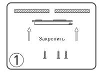
Закрепите монтажное основание светильника в месте установки при помощи шурупов. Питающий кабель должен проходить через отверстие в середине закрепляемого основания.
