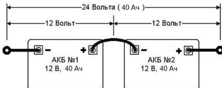
Для увеличения выходного напряжения АКБ подключают последовательно. Следует использовать изделия одинаковой ёмкости, модели и степени износа.
