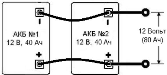
Для увеличения ёмкости АКБ подключают параллельно. При этом АКБ обязательно должны быть одного уровня заряда и одного напряжения (см. рисунок выше). Сопротивление кабелей каждого соединения должно быть одинаково, - для чего используйте кабели одинаковой длины и сечения.
