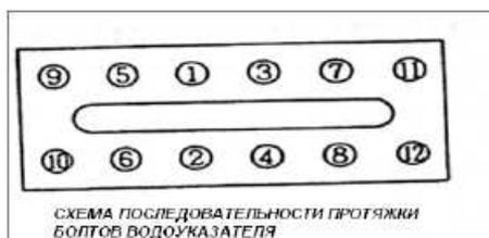
СХЕМА ПОСЛЕДОВАТЕЛЬНОСТИ ПРЯЖКИ БОЛТОВ ВОДУКАЗАТЕЛЯ
