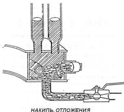
Для продолжительной эксплуатации парового котла кроме подготовки, подаваемой на котел воды, а также вместе с автоматической продувкой, **необходимо периодически производить его основную продувку**, с целью удаления **из нижнего коллектора котла** шлама (взвешенных частиц).
