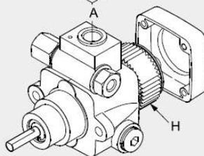
2-трубный режим: С винтом (A)      1-трубный режим: Без винта (A)
