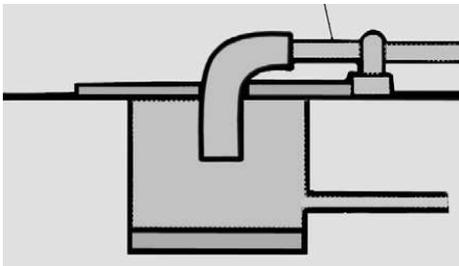
Сливной патрубок дренажного трубопровода должен быть аккуратно «заведен» в дренажный приямок (канал), имеющий достаточный объем для обеспечения безопасного слива воды из котла.
