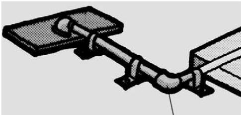
Дренажный трубопровод должен быть зафиксирован, чтобы исключить возможность вибрации.
