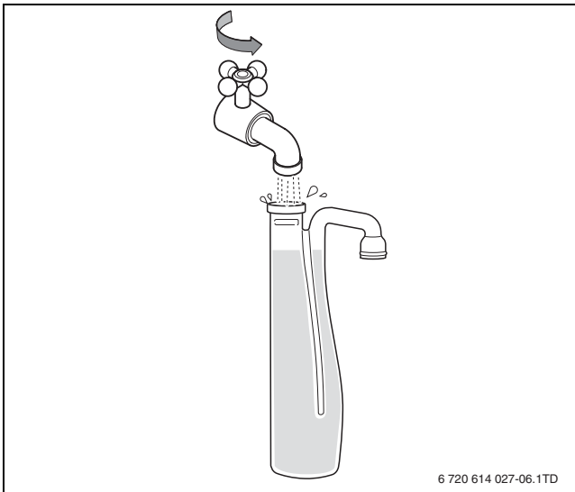
Рис 12 Наполнение сифона водой
