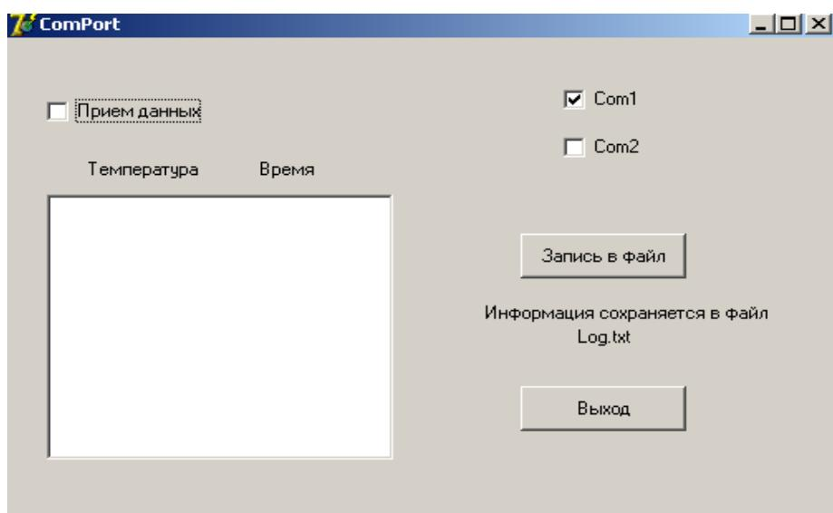
В случае, если стерилизатор был подключен к порту COM 2 , необходимо выбрать соответствующую графу из списка, поставив галочку в пункт COM2 в рабочем окне. При загрузке программы по умолчанию выбирается порт COM1. После выполнения этих операций можно начать прием данных от стерилизатора. Для этого необходимо поставить галочку в пункте “Прием данных”. При этом пункты Com1 и Com2 становятся недоступны.
