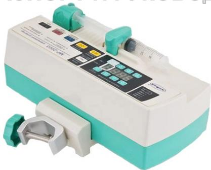
**Дозатор шприцевой для внутреннего вливания «Armed»: МР-2003** (далее по Руководству - дозатор/насос) - это компактный портативный шприцевой дозатор, предназначенный для внутривенного, внутриартериального или подкожного введения определенного количества лекарственных препаратов и медикаментов со скоростью, устанавливаемой пользователем. Предназначен для использования в медицинских лечебных учреждениях, а также в машинах скорой помощи.
