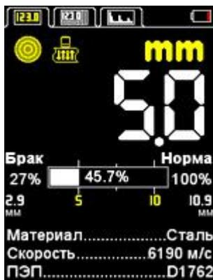
Применяется для оперативного определения толщины изделия с оценкой принадлежности результата измерений заданному интервалу и критерию срабатывания автоматической сигнализации дефекта (АСД).
