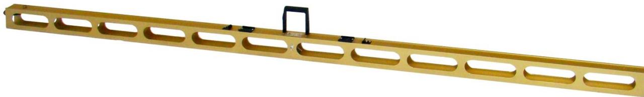
Рисунок 4 – Общий вид рейки дорожной универсальной РДУ-КОНДОР-Э-Н
