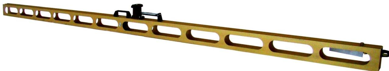
Рисунок 2 – Общий вид рейки дорожной универсальной РДУ-КОНДОР-Н
