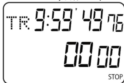
При нажатии на кнопку (2), прибор перейдёт в режиме обратного отсчета времени. В первой строке дисплея будет отображаться время обратного отсчета, а во второй строке – количество циклов обратного отсчета.
