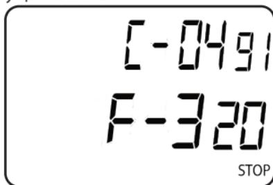
Для остановки отсчета нажмите кнопку (2). Для сброса счетчика сигналов нажмите кнопку (1).
