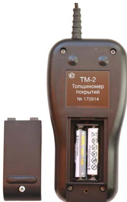
Рис 1-1 Вид прибора со снятой крышкой батарейного отсека
