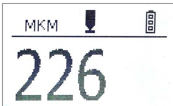
Рис. 2-2 Результат калибровки на образце 226 мкм
