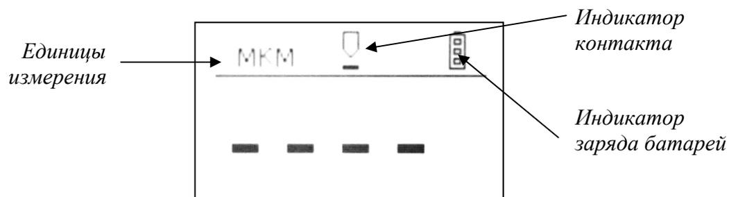
Рис.1-2 Общий вид индикатора ТМ-2 после включения
