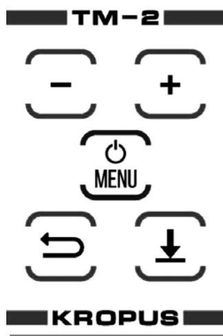
Рис. 1-3 Клавиатура толщиномера
