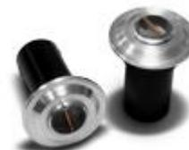
Преобразователь **П112-5-12/2-АТБ-902** работоспособен при температурах от +10°C до + 250°C (с кратковременным прижатием длительностью не более 6 секунд - до+350 °C).
