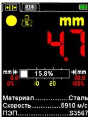
Применяется для оперативного определения толщины изделия с оценкой принадлежности результата измерений заданному интервалу и критерию срабатывания автоматической сигнализации дефекта (АСД).
