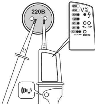
При тестировании постоянного напряжения подсоедините щуп L2 к положительному выводу, а щуп L1 – к отрицательному выводу источника напряжения. О наличии напряжения оповещает горящий светодиод. Также горит индикатор положительной полярности.
