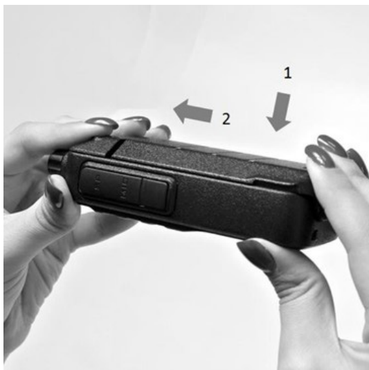
Рис. 2. Установка аккумуляторной батареи.
