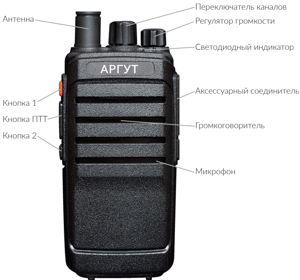
Рис. 1. Расположение органов управления, индикации и соединителей.
