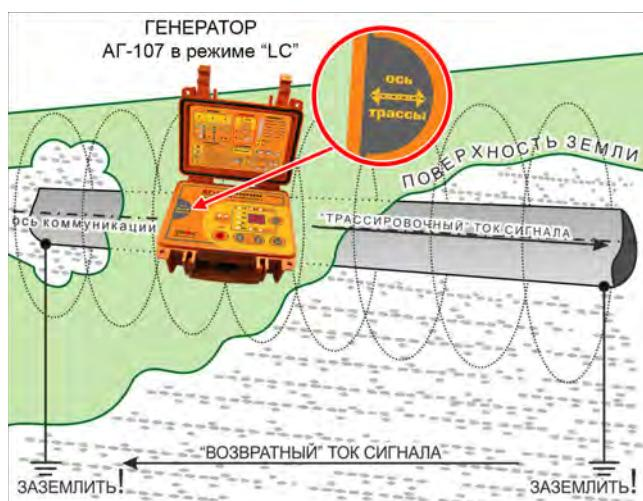
Не следует проводить трассировку в непосредственной близости от передающей антенны, так как воздействие передающей антенны на приемник искачет результаты трассировки.
