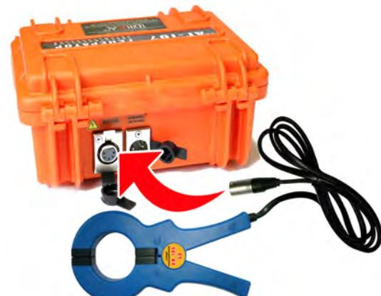
1.15.5. Затем при отсутствии генерации следует охватить клещами «выделенную» коммуникацию до полного смыкания магнитопровода клещей. Размыкание клещей и, соответственно, их переустановку на другую коммуникацию допускается производить только при отсутствии генерации.
