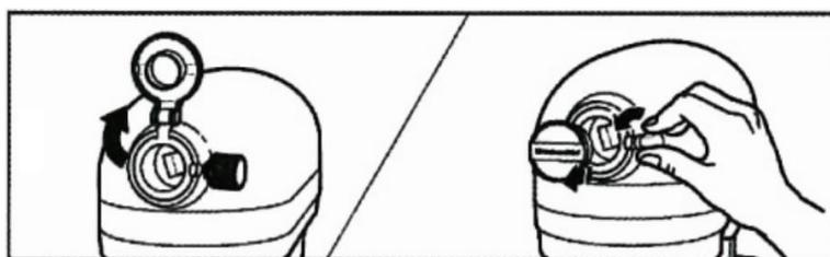
2. Поверните ручку крепления против часовой стрелки, если необходимо открыть крышку. Чтобы закрыть крышку поверните ручку крепления против часовой стрелки.
