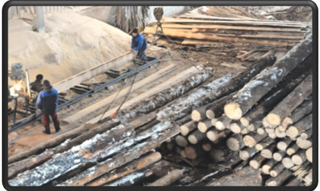
*В производстве используется сосна и ель. Мы изготавливаем материал сечением до 300мм. Стандартная длина до 6 метров. Оптимальный размер для строительства бань 150X150мм.*
