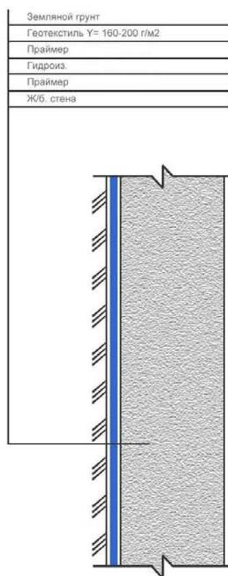
Конструктивное решение наружной гидроизоляции подвалов жилых зданий
