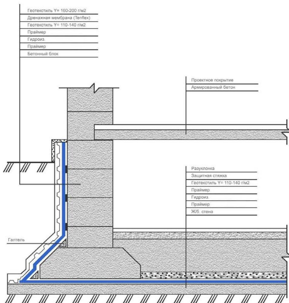
Конструктивное решение наружной гидроизоляции подвалов со стенами из железобетона на свайном основании
