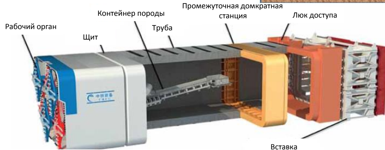
ТПМК для продавливания труб прямоугольного сечения
