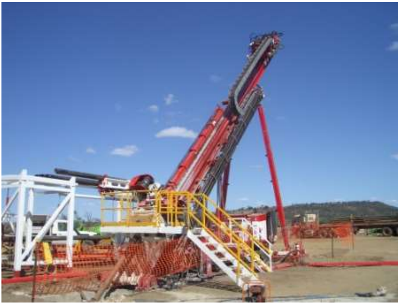
Рис. 4. Установка для наклонного бурения на проекте в Австралии
