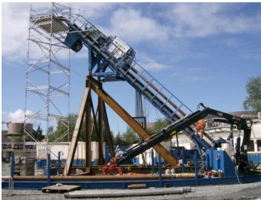
Рис. 3. Станок ГНБ в Норвегии. Модификация недостаточна для бурения скважин в горно-рудной области.
