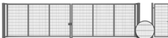
рис. 7. Двухстворчатые ворота с заполнением в форме решетчатых панелей VEGA 2D Super, привариваемых к конструкции.
