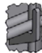
рис. 55. Монтаж панели на крючке
