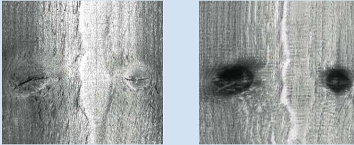
Links das Helligkeitsbild eines Schnittholzes, rechts das Streulichtbild (Tracheiden). Beachten Sie, wie viel dunkler die Astlöcher im Vergleich zum Helligkeitsbild erscheinen. Dadurch wird die Astlocherkennung wesentlich leichter und zuverlässiger.
