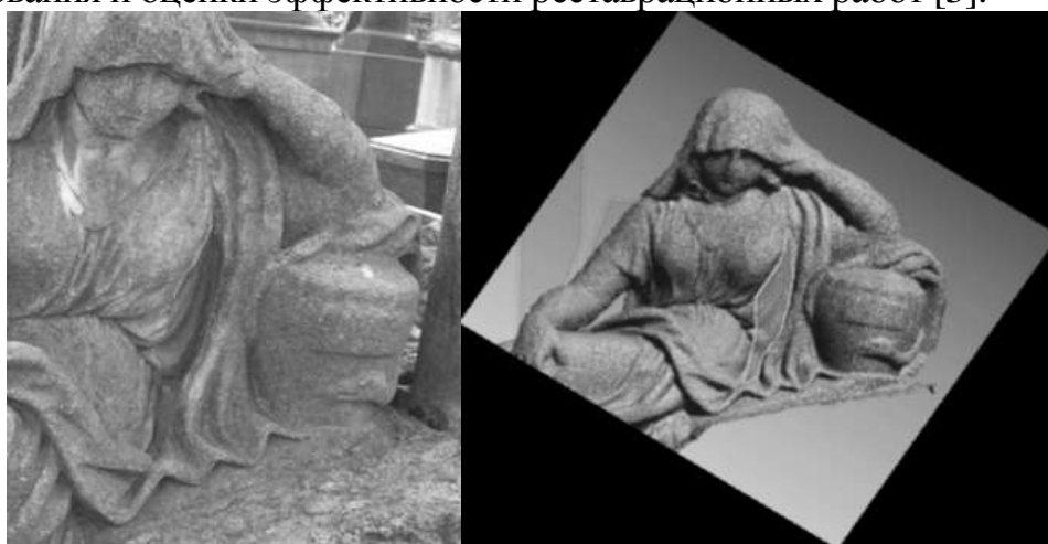
Рис.4. Пример фиксации гипсовой корки на памятнике А.Я. Охотникову (Некрополь XVIII века) с использованием 3D-лазерного сканирования: а) фото; б) 3D модель.
