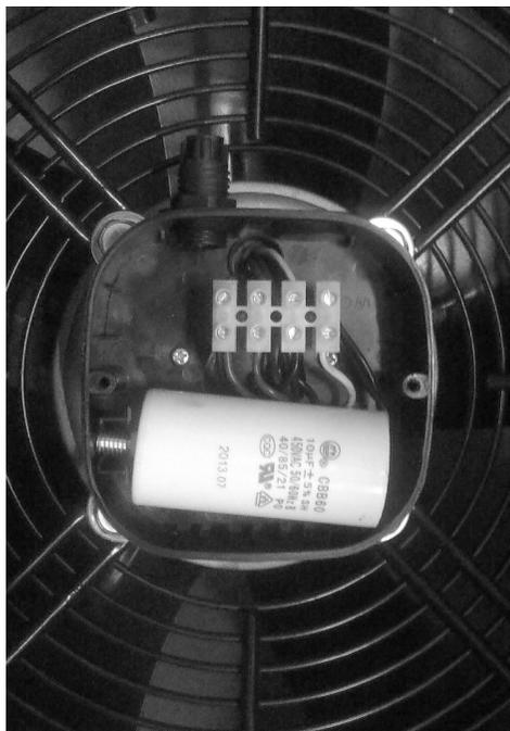
Минимальное сечение электрических проводов – 1 мм<sup>2</sup>
