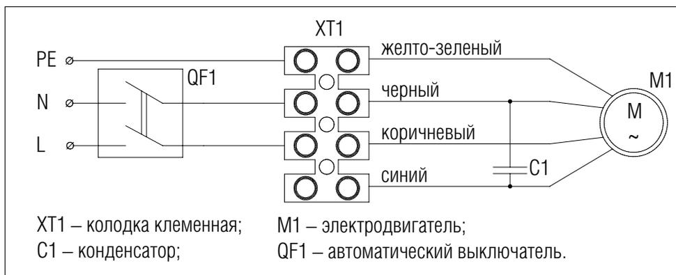
Для подключения электропитания снимите крышку с электродвигателя открутив два винта. Подключите провода к клемной колодке согласно схеме подключения. Установите крышку обратно.
