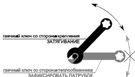
Рис. 5. Подключение к системе подачи теплоносителя.
