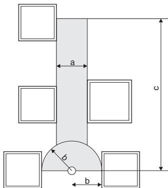
Если оголовок вывода располагается на расстоянии  $d > 0,3$  м от верхней части оконной рамы, то образованная около него зона не может пересекаться с плоскостью окна. При удалении на расстоянии  $d < 0,3$  м плоскость, ограниченная радиусом  $b$ , может пересекаться с верхней гранью окна.
