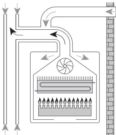
При заборе воздуха для процесса горения из внутренних помещений здания необходимо обеспечить в них его достаточное количество. К трассе отвода продуктов сгорания (будь то дымоход, или трубопровод) не может быть подсоединен никакой иной прибор, а для необходимого забора воздуха горения должен быть обеспечен достаточный приток воздуха, минимально  $1,2 \text{ м}^3/\text{час}$  на  $1 \text{ кВт}$  мощности котла.
