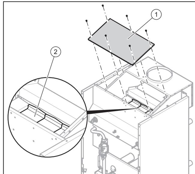
3. Выверните винты крепления щитка (1) и снимите его.
