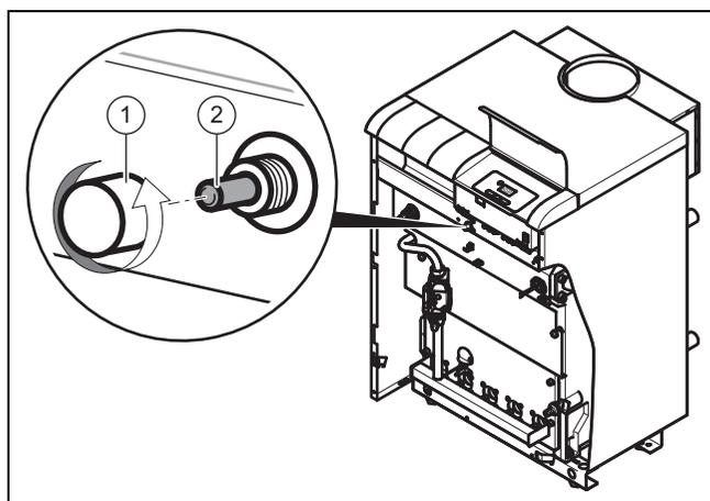
3. Поверните и снимите колпачок (1).
