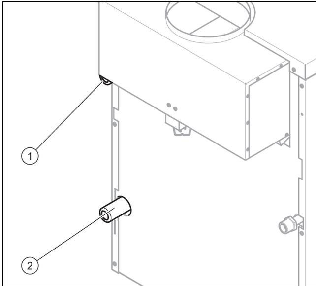
3. Подсоедините подающую линию системы отопления к подключению подающей линии системы отопления (1).
