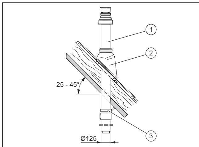
1. Определите место установки прохода через крышу.
