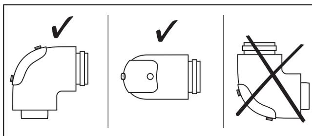
Неправильное установочное положение вызывает выход конденсата из-под крышки ревизионного отверстия и может стать причиной коррозионных повреждений.
