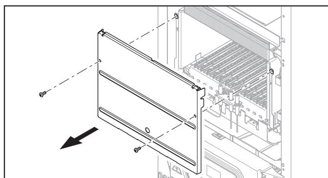
► Снимите крышку камеры сгорания, как показано на рисунке.
