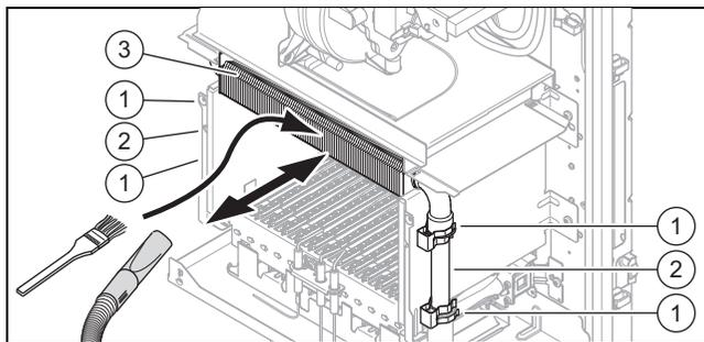
1. Снимите 4 скобы **(1)** на трубе подающей и обратной линии.
