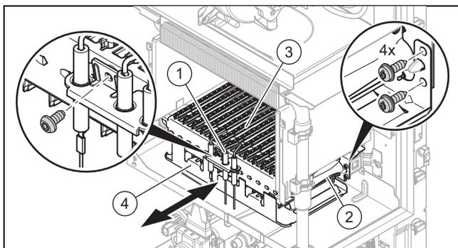
1. Открутите винты на газораспределительной трубе **(2)**.
