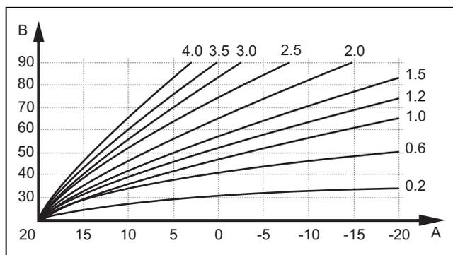
A Температура наружного воздуха [°C]      B Температура в подающей линии [°C]
