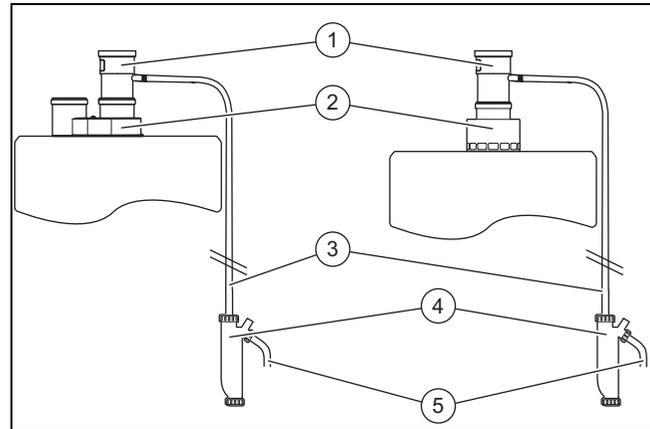
4. Вставьте отвод конденсата (1) в присоединительный элемент (2).
