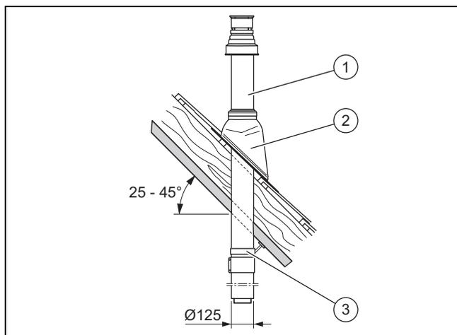
1. Определите место установки прохода через крышу.
