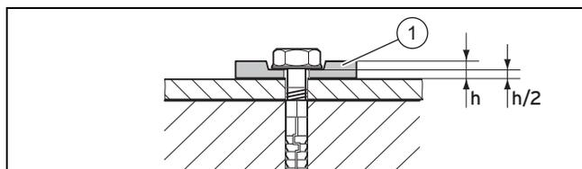
4. Закрепите основание оголовка шахты четырьмя винтами на краю устья.
