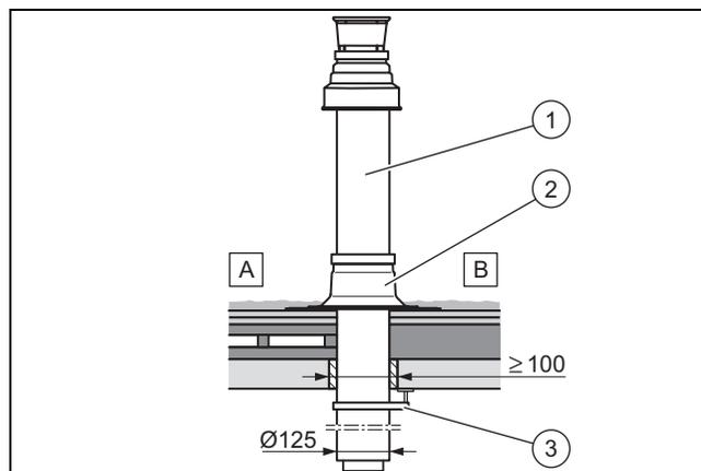
A Неутепленная крыша      B Утепленная крыша
