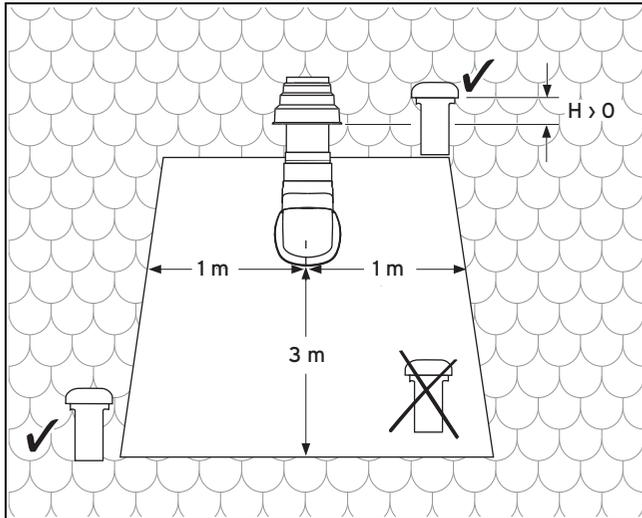
Из вытяжных каналов выходит очень влажный отводимый воздух. Он может конденсироваться в трубе подачи воздуха и вызывать повреждения прибора.
