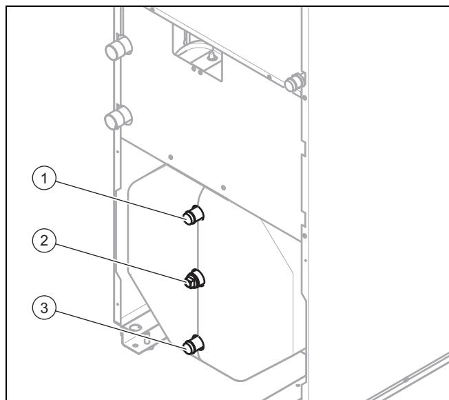
1. Подсоедините трубопровод горячей воды к штуцеру горячей воды (1).
