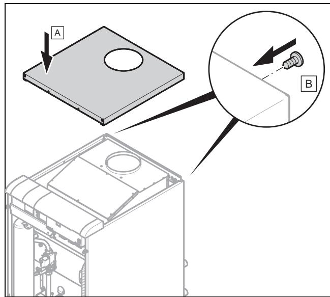
1. Наденьте крышку облицовки на изделие сначала сзади, а затем спереди.
