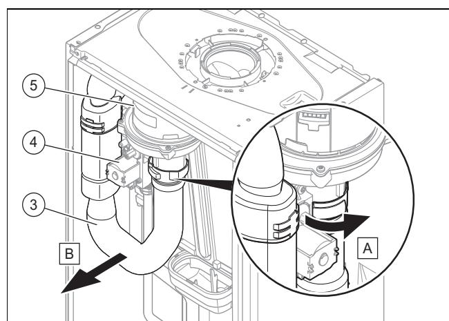
7. Снимите воздухозаборную трубу (3).
