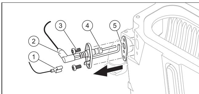
1. Отсоедините подключение (2) и кабель соединения с массой (1) от клемм.
