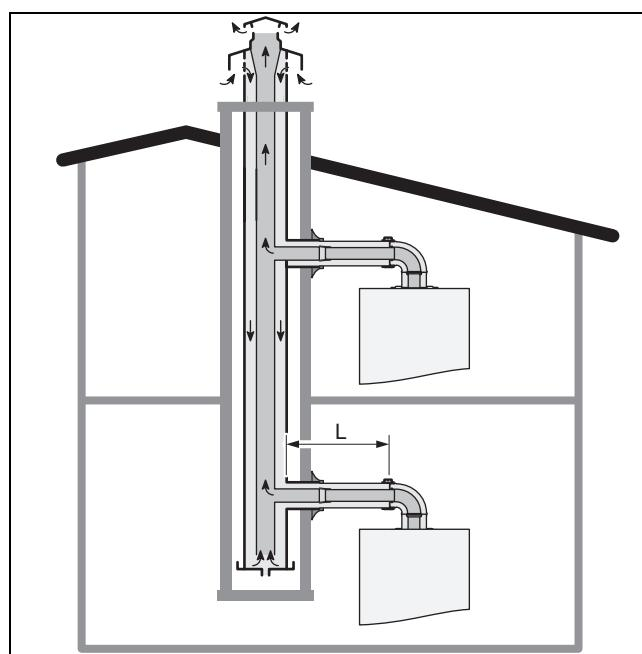
Соединение с магистралью осуществляется с помощью принадлежностей, специально разработанных изготовителем прибора.
