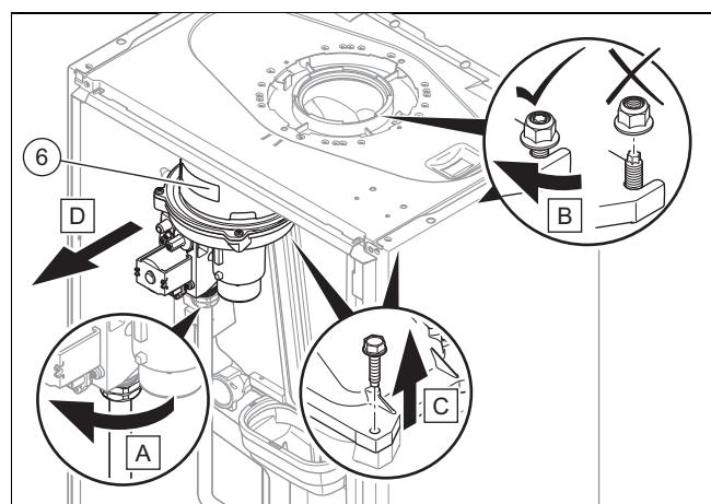
9. Снимите газовоздушный тракт (6).
