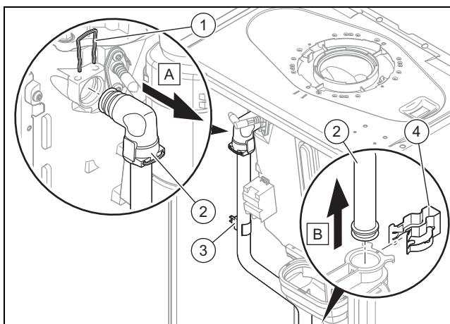
4. Снимите датчик температуры (3).
