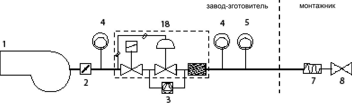
Газовая рампа с группой клапанов MBC1900-3100-5000SE со встроенным стабилизатором давления газа + блок контроля герметичности VPS504
