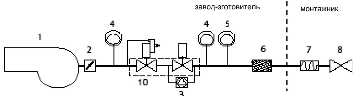
Газовая рампа с группой клапанов MBC1200SE со встроенным стабилизатором давления газа + блок контроля герметичности VPS504
