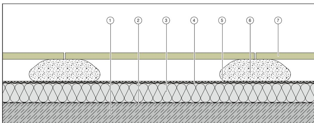
Сухая укладка на теплоизолированное плоское покрытие
