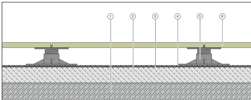
Сухая укладка плитки на регулируемые опоры поверх плит фундамента или бетонных плит перекрытия
