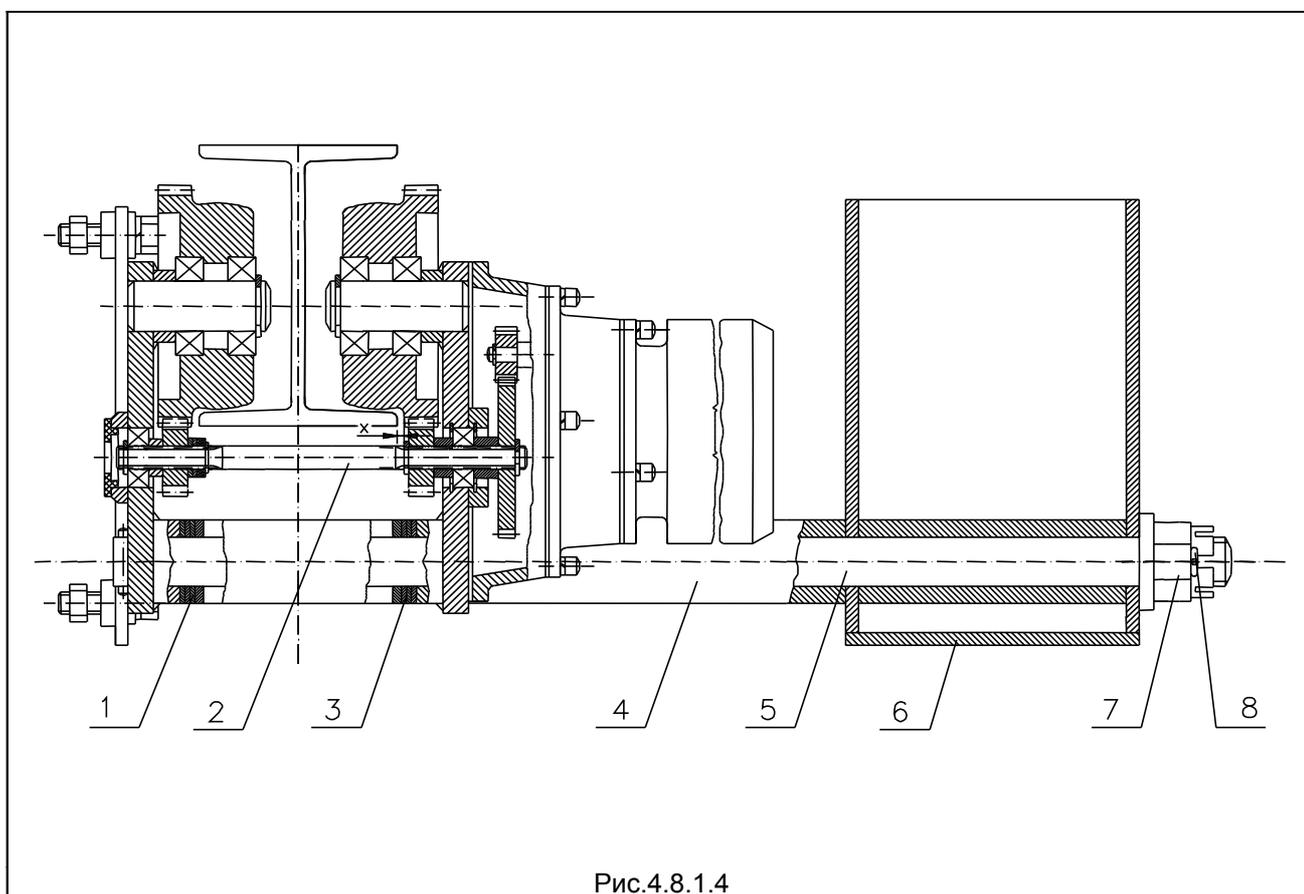
Монтаж аналогичен указанному в п. а). Здесь, соответственные ширины постигнуты путем сочетания набора втулок поз. 1, 3, 4 шпилек 5, а настройка шайб приводящего вала полностью идентична настройке тали с нормальной строительной высотой.
