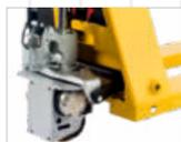
· Электродвигатель на рулевом колесе
