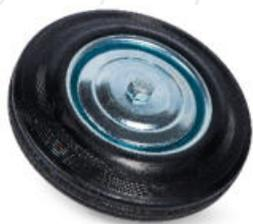
Применяется для оснащения тележек различного назначения. Диск (обойма) колеса - сталь. Покрышка - литая резина. Игольчатый подшипник на ступице обеспечивает низкое трение качения и легкий ход. Ступица защищена от загрязнения стальными колпаками.
