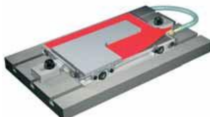
Желобковое зажимное устройство с перфорированным резиновым переходным матом
