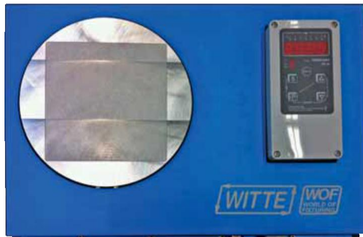
Специальная версия с интегрированным электронным устройством контроля нагрева и температуры
