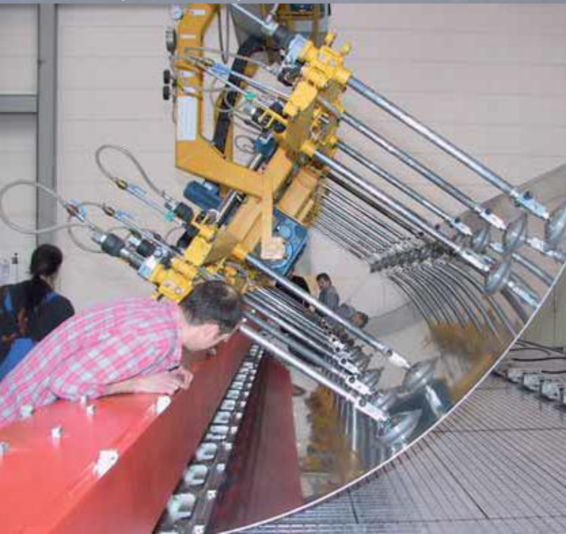
Зажимные устройства для механической обработки предварительно отформованных частей фюзеляжа самолета (13м x 4,10м) Детали прижимаются, вращаются в плоскости и закрепляются вакуумным, пневматическим и гидравлическим креплениями
