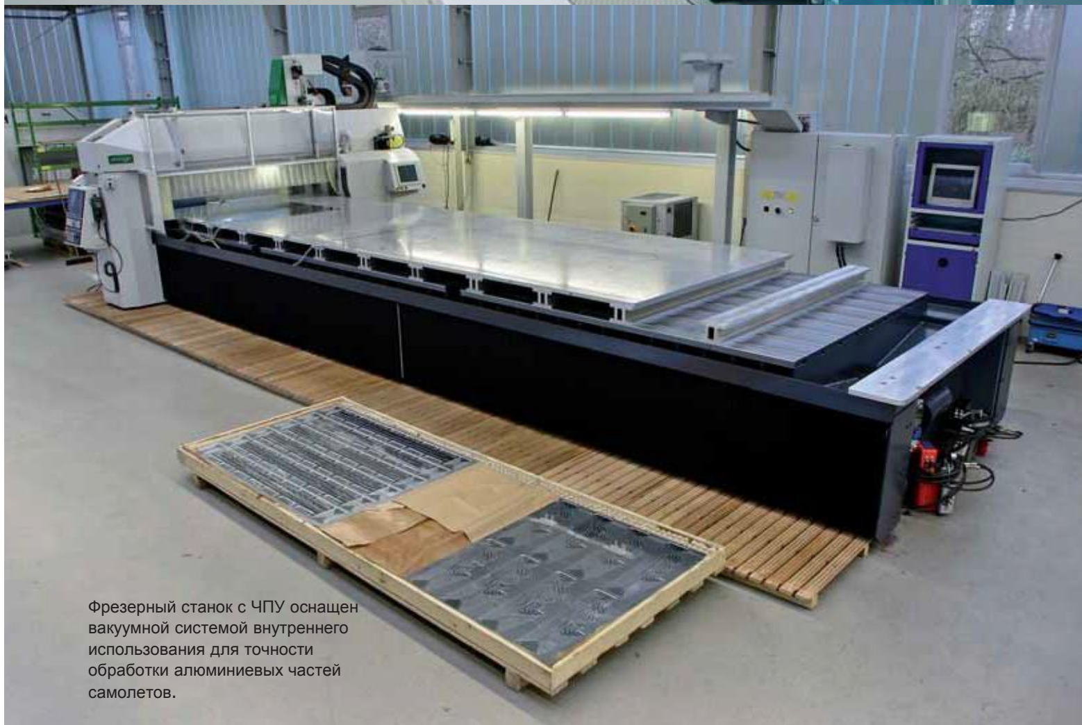
Стол для обработки (3,3x11 метров) поставляется с системой фиксации вакуумом VAC-MAT™. На фото показана установка, используемая производителем авиационной техники. Рабочую поверхность составляют 468 матов.
