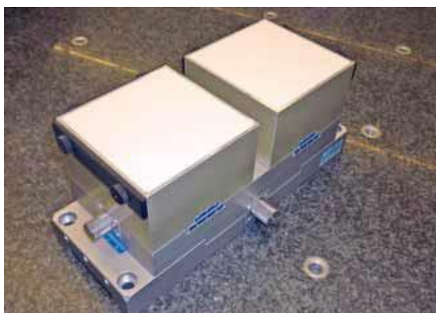
Система двойного стола с двумя поверхностями закрепления. Столы можно точно выровнять друг относительно друга
