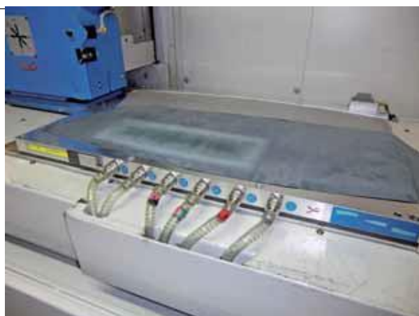
Применяется в автомобильной промышленности, с зажатой кожей на видимой стороне для шлифования заранее определенных точек разрыва в зонах подушек безопасности на обратной стороне
