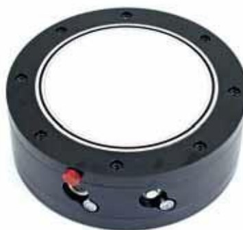
Отдельное вакуумное зажимное приспособление. Зажим деталей на зажимном приспособлении не включает наружных коммуникаций. Батарея, вакуумный насос, устройства управления, дисплей и клапаны встроены
