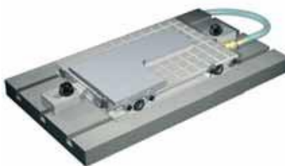
Решетчатое зажимное приспособление с О-образным уплотнение
