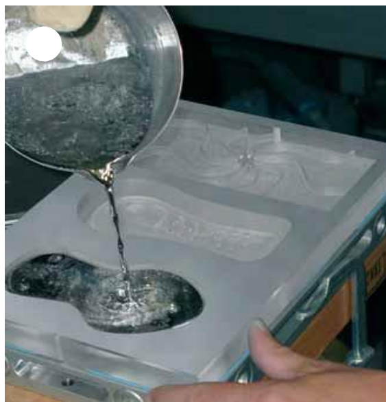
Справа: Заполнение форм расплавленным сплавом Witte Weiguss
