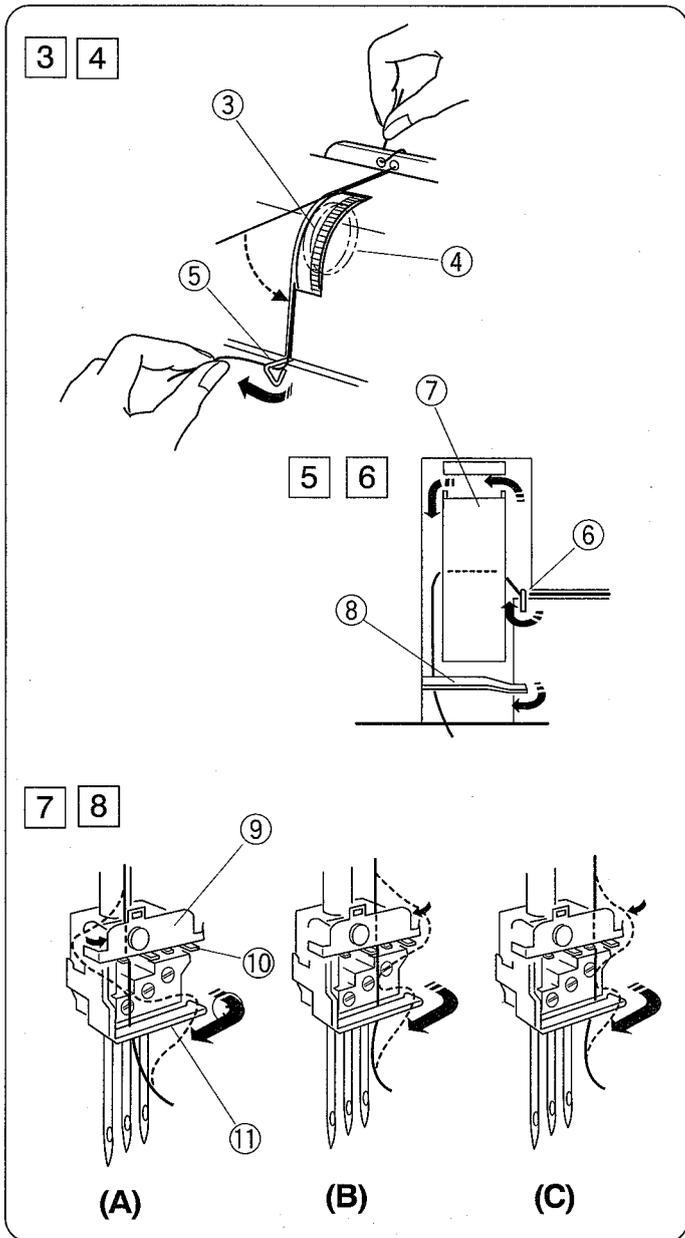
3 Удерживая нить с двух сторон, вставьте ее между дисками натяжения, немного натяните. ( Если поднят рычаг прижимной лапки, нить легко пройдет между дисками натяжения).
