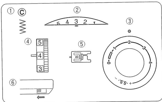
Удалите нить из иглы. Измените ширину зигзага так, чтобы игла сквозь прорезь на лапке попадала в отверстия пуговицы. Поверните маховое колесо и проверьте, входит ли игла в отверстия пуговицы. Опустите прижимную лапку, чтобы закрепить пуговицу на месте. Отверстия в пуговице должны совпадать с прорезью на лапке.
