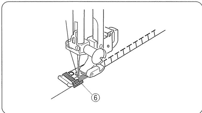
Этот стежок подходит для обработки срезов тканей стреч. Он одновременно делает шов и обрабатывает его.
