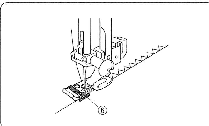
Этим стежком обрабатывается край материала для предотвращения обсыпания нитей. Его можно использовать для завершения шва.
