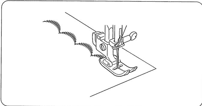
Определите необходимую плотность стежков на пробной полоске ткани.
