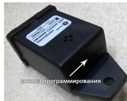
Контроллер переходит в режим программирования пользовательских установок. При этом сразу выбирается первый параметр (первая строка в таблице программирования). Узнать значение установленного параметра нет возможности. В случае сомнений в правильности выбранного значения, необходимо с помощью последовательного нажатия кнопки «пройти по кругу» для выбора нужного значения.
