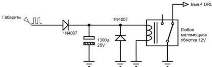
В случае наличия в автомобиле схемы контроля целостности нитей накала, а также в случае выявления проблем при подключении к цепи габаритов автомобиля (контроллер «не видит» сигнал габаритов) можно подключить контроллер к цепи габаритов с использованием любого маломощного реле с переключающимися контактами и напряжением управления равным бортовому напряжению автомобиля.
