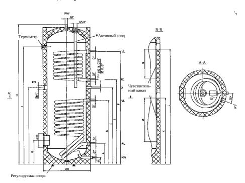
Размеры (мм) Тип Н ØD Α В K M N STA400C STA500C
